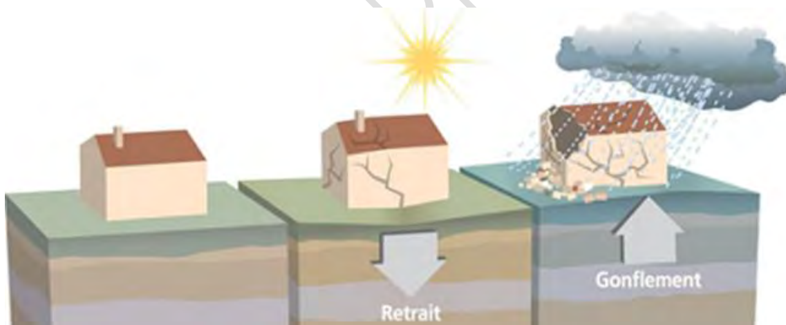
Illustration sur l'aléa retrait-gonflement des sols argileux
